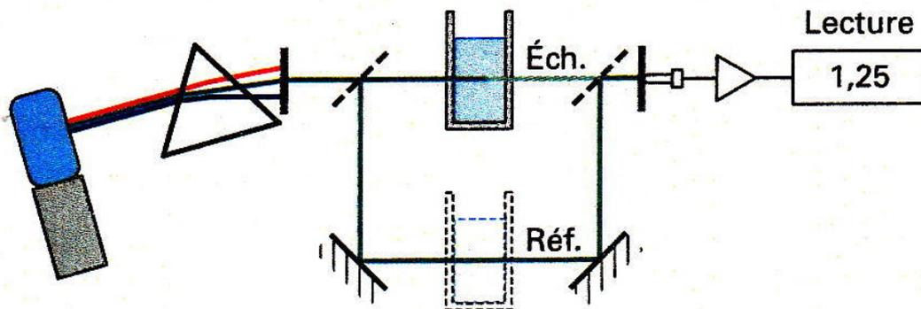
Figure 1 : Synoptique d'un spectrophotomètre double-faisceau
