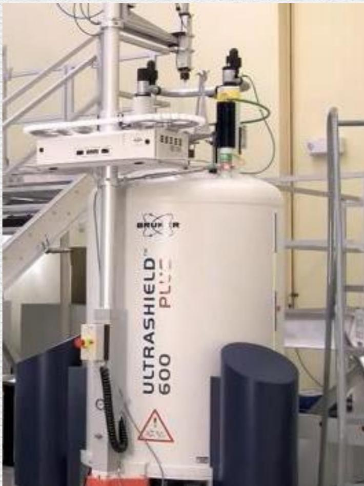
Un champ magnétique statique  $B_0$  aussi *homogène et stable* que possible est appliqué à l'échantillon. Ce champ (par exemple : 14,1 T, à 600 MHz) est obtenu grâce à une bobine supra-conductrice plongée dans un cryostat rempli d'hélium liquide (- 269 °C)).
