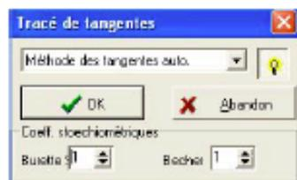
Cliquer sur un des points correspondants aux mesures resserrées avant l'équivalence, les tangentes se tracent automatiquement :
